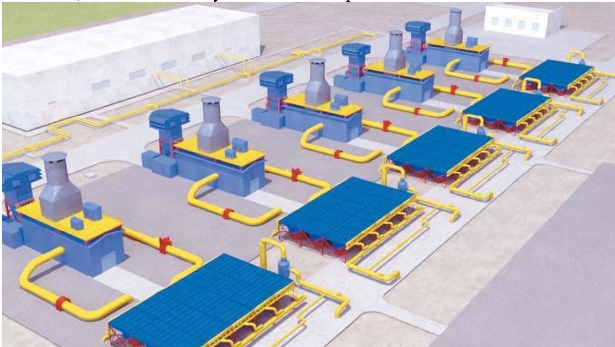
Рис. 1.7. Блочно-модульная схема обвязки основного технологического оборудования КС
